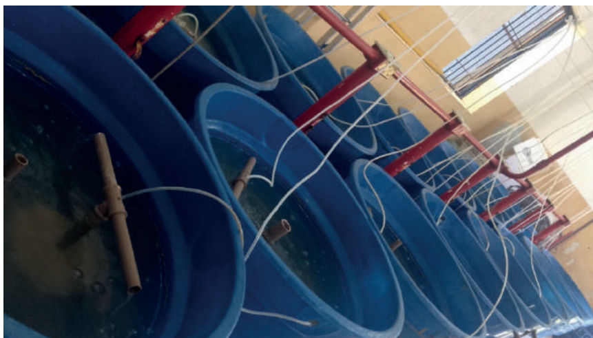
Figura 2. Sistema de recirculação fechado dinâmico com filtro biológico interno utilizado no Laboratório de Carcinicultura da Universidade Federal do Recôncavo da Bahia (UFRB).
