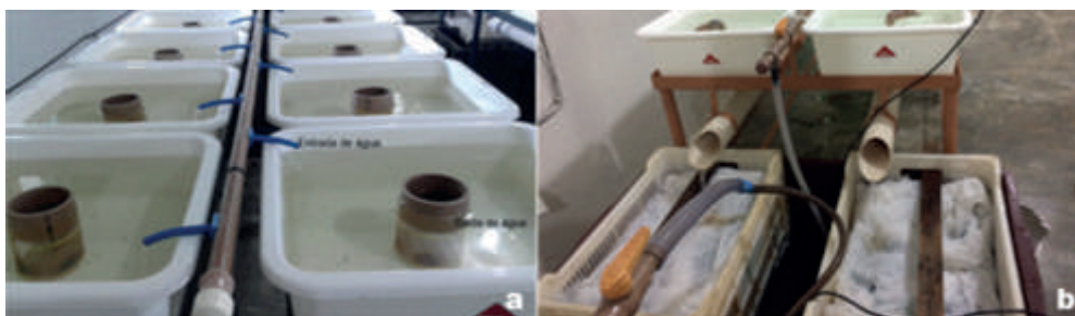
Figura 1. Sistema de larvicultura utilizado, mostrando as bandejas (a) e o filtro mecânico (b)
